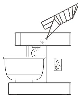
温馨提示：防护罩抬起后，机器会自动断电，因此运行前务必把防护罩盖上，否则机器无法运转。
